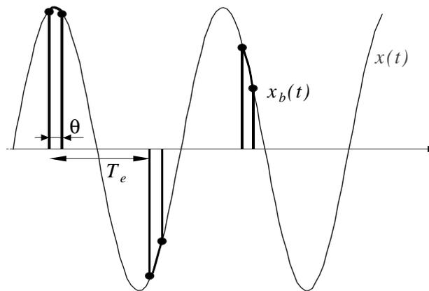
Exprimer le signal  $x_b(t)$  comme le produit de  $x(t)$  avec une somme de fonctions portes que l'on précisera. Déterminer alors la transformée de Fourier de  $x_b(t)$ . On suppose que la condition  $F_e > 2F_{\max}$  est vérifiée. Qu'obtient-on lorsqu'on filtre le signal  $x_b(t)$  par un filtre passe bas idéal de transmittance  $H(f) = \Pi_{F_e}(f)$  ?
