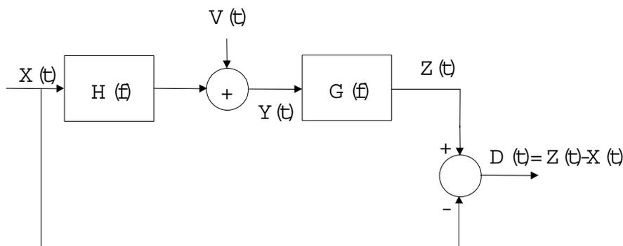
Tous les signaux représentés sur cette figure sont des signaux aléatoires supposés stationnaires. On suppose de plus que le bruit  $V(t)$  est de moyenne nulle et qu'il est indépendant de l'entrée du système  $X(t)$ . On utilisera les notations habituelles pour représenter les fonctions d'autocorrélation et densités spectrales de puissance (i.e.  $R_X(\tau)$  et  $s_X(f)$  pour le signal  $X(t)$ ).
